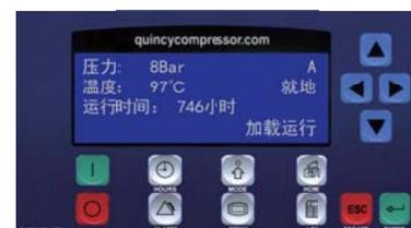
**PLC 智能控制系统** 安全，节能，界面友好。标准西门子 PLC，系统扩展方便，可与 DCS 系统进行通讯，轻松实现远程监控。
